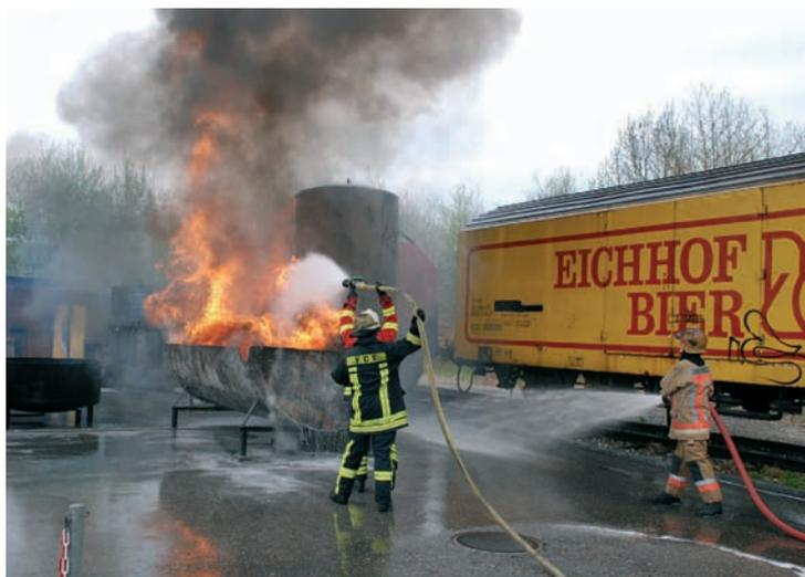
una actuación directa hasta neutralizar por completo, cada una de las moléculas de los líquidos inflamados. Incluso en el caso de líquidos explosivos, la neutralización es total y permanente, sin que exista riesgo de avivamiento. Con la formación de una espesa capa de espuma del todo estable y que flota sobre una fina membrana que actúa como elemento aislante, se evita el contacto del oxígeno con los materiales líquidos o sólidos inflamados, así como con los vapores tóxicos.
